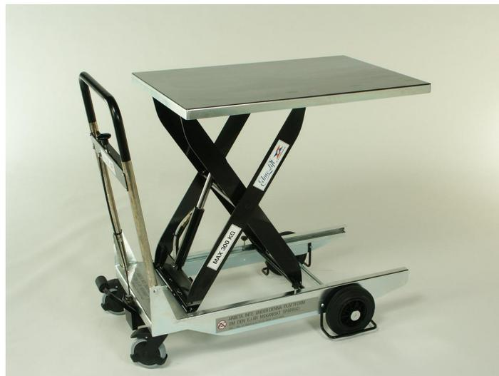
La gamme TZ d'Abeyor est une gamme de Tables Elévatrices Mobiles et de plates-formes de travail. Robustes, facilement maniables, elles se prêtent à de nombreuses opérations. Elles offrent une vaste gamme de modèles et performances et notamment une capacité de charge allant de 200 kilos à une tonne ainsi qu'une course de levage comprise entre 920 mm et 1.620 mm.
