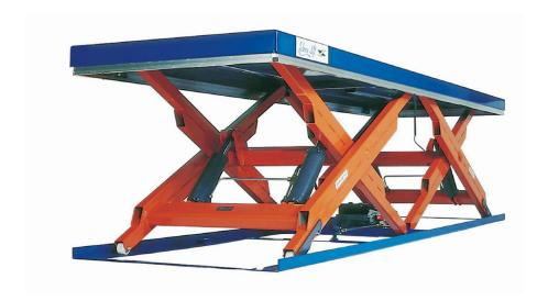
Les Tables Elévatrices à Doubles Ciseaux Horizontaux donbeyor sont la solution idéale pour la manutention de charges longues et lourdes et pour tout besoin qui requiert une table élévatrice sophistiquée. Elles offrent une vaste gamme de modèles et performances avec une capacité de charge de deux à dix tonnes, une course de levage comprise entre 820 mm et 2.000 mm, ainsi quoune taille maximale pouvant atteindre 6.200 mm par 1.500 mm.
